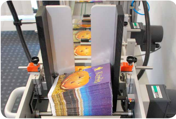
Das Magazin der eMATRIX T2137 mit Zählwerk sorgt für unterbrechungsfreie Kennzeichnungsprozesse.
