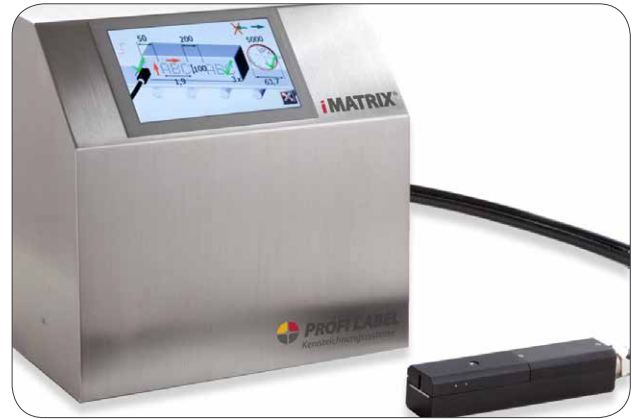
Zur effizienten Variablen-Beschriftung (z.B. MHD oder Charge) kann die Anlage um Inkjet-Systeme erweitert werden.
